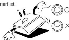
Die Waage fern von elektronischen Geräten halten – deren Magnettfelder könnten die Genauigkeit beeinflussen.
