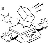
Zum Transportieren immer unter die Waage fassen. Niemals an der Platte oder am Stativ tragen.
