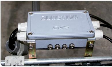
**JB-4** → Gehäuse aus Aluminium → wassergeschützt und staubdicht nach Schutzart IP65 → 4 Wägezellen → Leiterplatte mit 4 Trimmern (Potentiometern) → von außen ohne Öffnen des Gehäuses justierbar → inklusive Verschraubungen und Dichtungen
